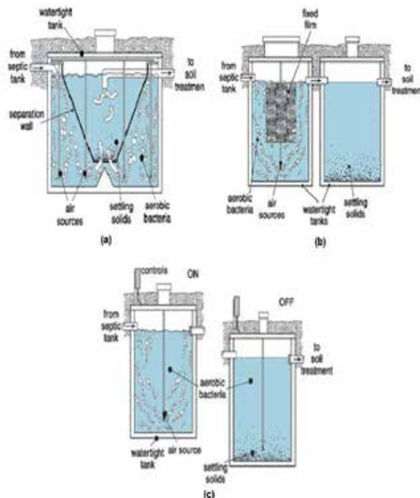
**Fig. 4 : Aerobic Treatment Units**
