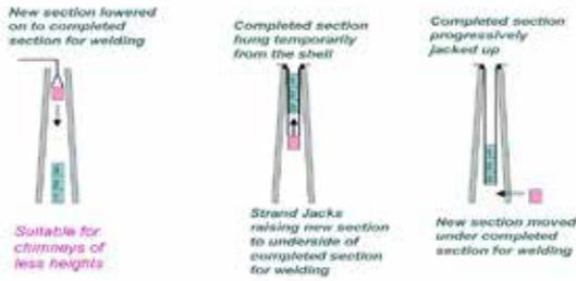
**Fig. 28: Flue Erection**
