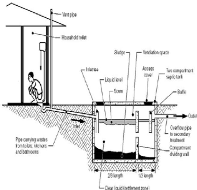
**Fig. 2 : Septic Tank System**
